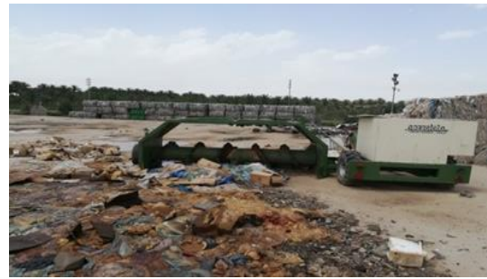
شكل (12): ماكينة تقليب وتقطيع النفايات لانتاج السماد العضوي.
